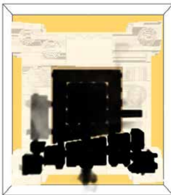
PROPAGAZIONE DEI FUMI AL PIANO TERRA - SCENARIO 2 – SENFC PRESENTE Tempo di simulazione: 700 s > RSET + t_{\text{marg}}
