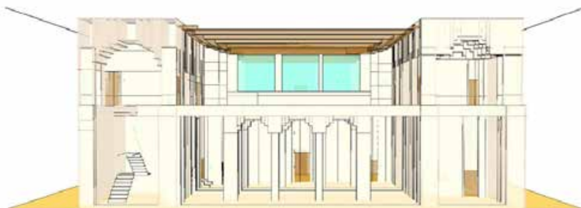
Sezione della zona scala 1 modellata con FDS
