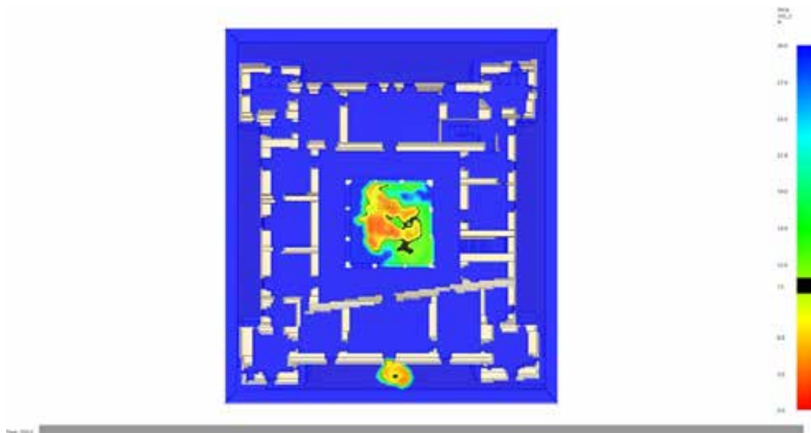
PROPAGAZIONE DEI FUMI AL PIANO PRIMO – VISIBILITÀ ( z = 1,80 m rispetto al piano calpestio) SCENARIO 2 – SENFC PRESENTE – Tempo di simulazione: 700 \text{ s} > \text{RSET} + t_{\text{marg}}
