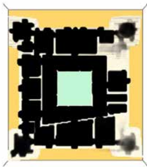
PROPAGAZIONE DEI FUMI AL PIANO PRIMO - SCENARIO 1 – SENFC NON PRESENTE Tempo di simulazione: 700 s > RSET + t_{\text{marg}}
